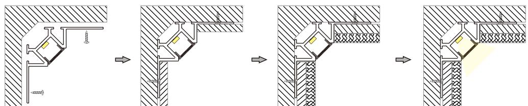
1, Fije el H.D. a la superficie de colocación mediante tornillos y tacos.
