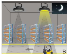
Si la luz ambiente es menor de lo necesario (establecido manualmente) y el sensor detecta movimiento, entonces las luminarias se activan automáticamente hasta alcanzar la iluminación deseada (Active level).
