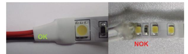
Imagen 8. Protección de unión cable-tira LED mediante termo-retráctil
