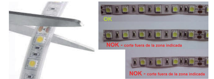
Image 5. Coupure de la bande LED OK et NOK
