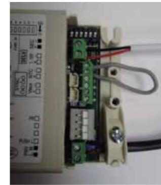
Image 4. Exemple de branchement à un driver 3030-33 MmA
