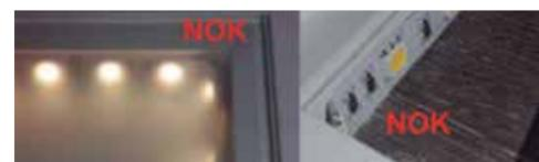
Image 9. Exemple NOK de réalisation de placement des bandes LED sur des montants d'angles, tournants ou changements de direction
