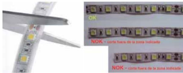
Image 5. Coupure de la bande LED OK et NOK
