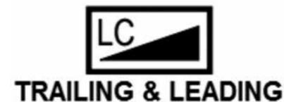
Imagen 7. Símbolo de compatibilidad con sistemas de regulación TRAILING y LEADING
