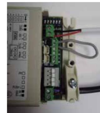
Imagen 4. Ejemplo conexión con driver 3030-33MmA
