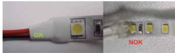
Imagen 8. Protección de unión cable-tira LED mediante termo-retráctil
