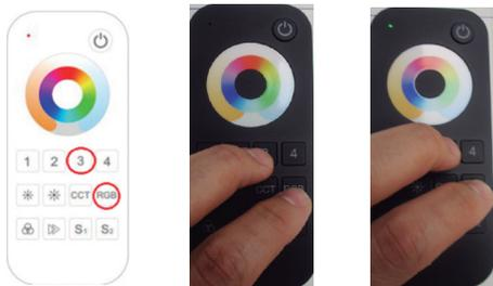
Après avoir réalisé cette opération, la Zone 3 de la commande contrôlera uniquement les bandes LED RGB de sorte qu'il sera seulement possible de régler l'intensité de la luminosité et le type de couleur (R/G/B), tandis que la roue des couleurs permettra de régler comme on peut le voir au centre de celle-ci qui correspond en plus aux caractéristiques suivantes :
