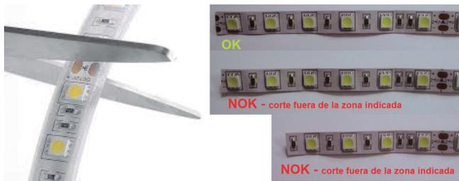
Image 5. Coupure de la bande LED OK et NOK
