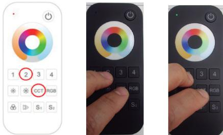
Après avoir réalisé cette opération, la Zone 2 de la commande contrôlera uniquement les bandes LED blanc tunable-TWV de sorte qu'il sera seulement possible de régler l'intensité de la luminosité et la température de couleur, tandis que la roue des couleurs permettra de régler comme on peut le voir sur les côtés de celle-ci qui correspond en plus aux caractéristiques suivantes :
