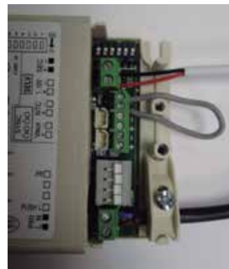
Imagen 4. Ejemplo conexión con driver 3030-33MmA
